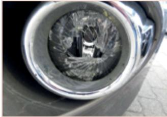
Optische Schäden, welche die Betriebs- und/oder Verkehrssicherheit nicht direkt beeinflussen (gilt für Front-, Seiten- und Heckscheiben sowie Beleuchtung)
